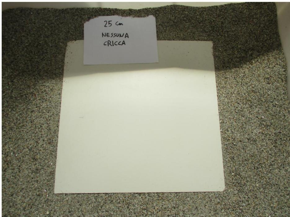
Figura 4. Riproduzione fotografica della parte frontale di un campione 300 mm x 300 mm x 20 mm del prodotto "Coprimuro in Marmoresina" al termine del test di resistenza all'urto (caduta della sfera di acciaio di diametro 63 mm e peso 1,0 kg da altezza 25 cm). Non sono stati osservati difetti.
